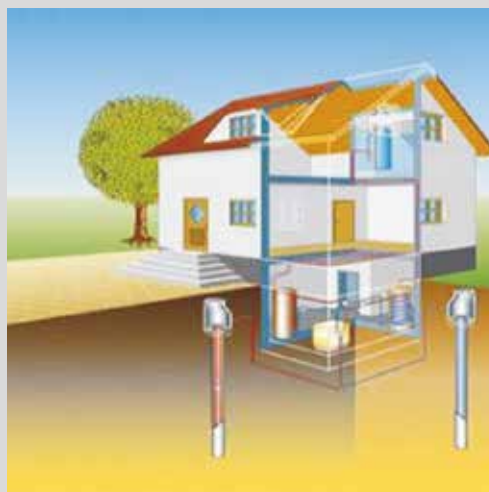
Anlagenschema - Förder- und Schluckbrunnen Wasser
