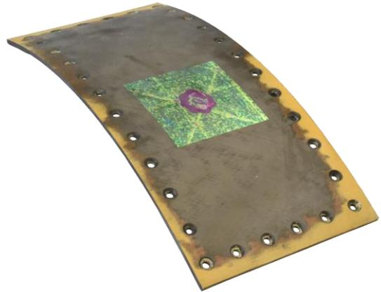
*Faserverbund-Probekörper mit projizierten Ultraschalldaten*
