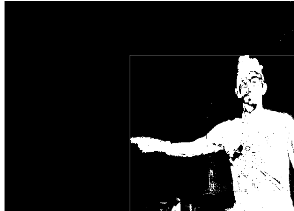
Fig. 3 Ausgabe des Hintergrundsegmentierers (ergänzt um eine Bounding Box)
